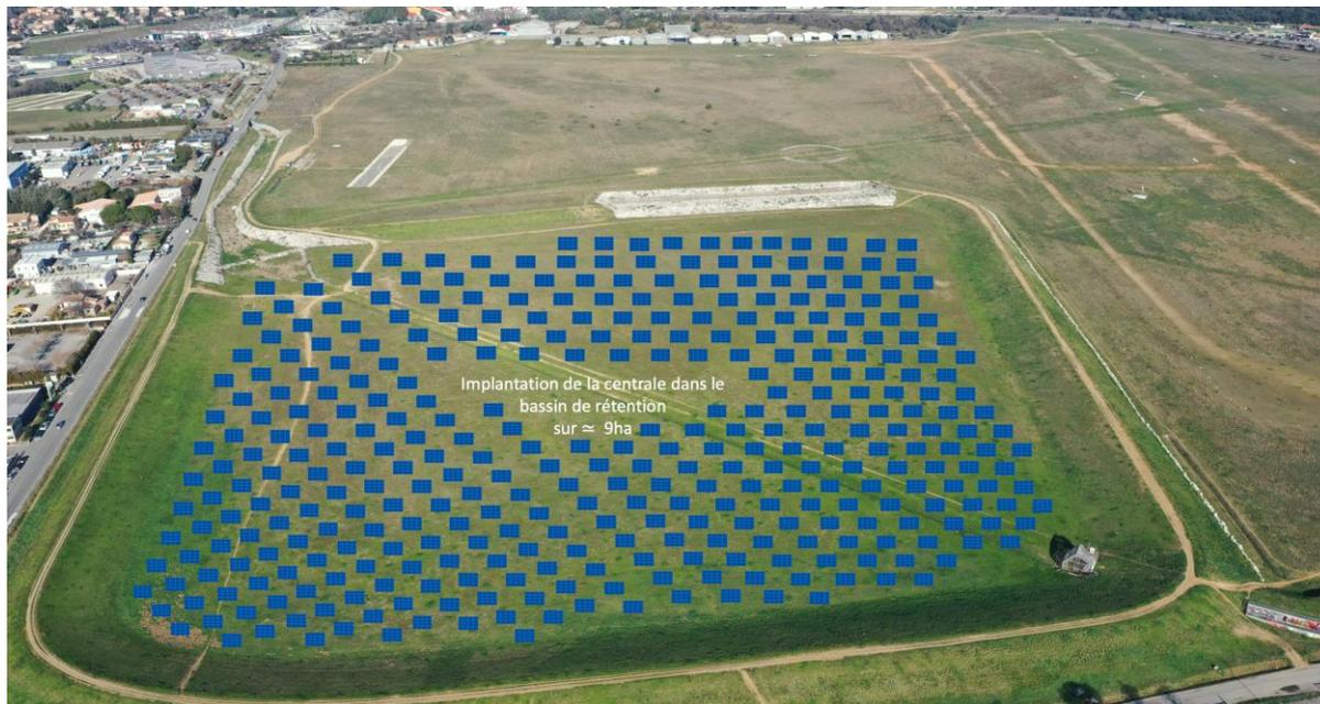
**Figure 6** : Zone 1 bis comprenant un parc photovoltaïque dans le bassin de rétention de l'aérodrome sur une superficie de +/- 09 hectares
